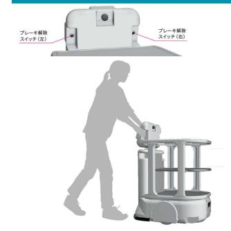
ロボットを移動する際は、必ず左右のブレー キ解除スイッチを同時に押しながら動かして ください。
